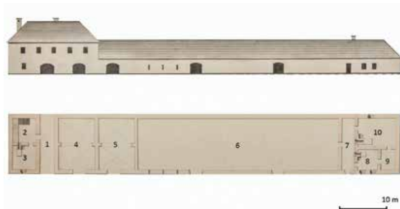
Ilustracja 2. Bodzentyn, przedzamcze, zabudowa murowana pierzei wschodniej fundacji biskupa Andrzeja Trzebieckiego (1675) – elewacja zachodnia i plan przyziemia wg pomiaru z 1820 r. (MNK, III-PI-3829, rys. Jacek Lipski, XI 1820) z oznaczeniem funkcji wewnątrz wg inwentarza z 1680 r. (AKKK, Inv.B.8, k. 2r-2v); oprac. graficzne i opis Michał Sobala: 1. „brama” (sienń przejazdowa), 2. „sienń” (ze schodami „na bramę do mieszkania starosty” na I piętrze), 3. „sklepik”, 4-5. „wozownia”, 6. „stajnia wielka”, 7-10. „maszarnia” (7. „sienń”, 8. „izdebka dla koniuszego”, 9. „alkierz”, 10. „izdebka dla woźnic”).
