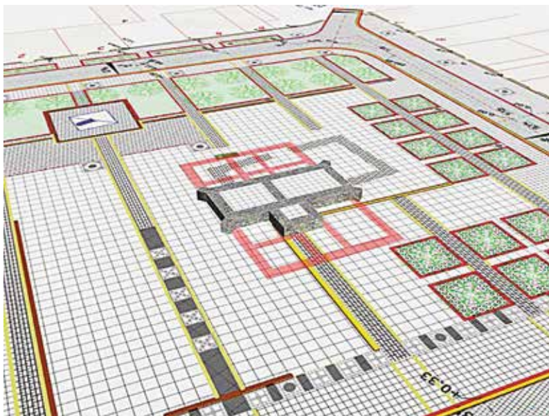
Ilustracja 15. Bodzentyn, Górny Rynek, badania wykopaliskowe we wrześniu 2012 r. Koncepcja uwidocznienia na projektowanej płycie Rynku obiektów odkrytych w trakcie badań (ratusz z XVI w., ratusz z XVII w., pręgierz). Rys. C. Hadamik
